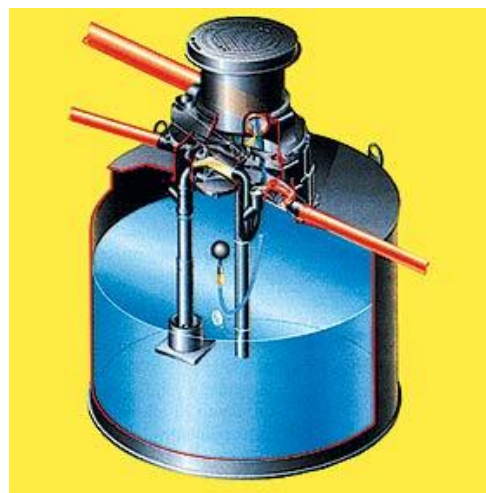
Рисунок 14. Типология компактного резервуара-моноблока, оснащенного системой фильтрации воды
