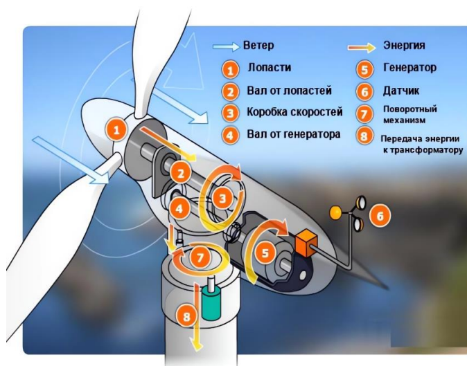
Рисунок 24 - Строение ветрогенератора
